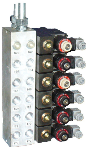
Пример монтажа гидравлических распределителей на многоместной плите EM213/6Y (шестиместная без встроенного предохранительного клапана)
